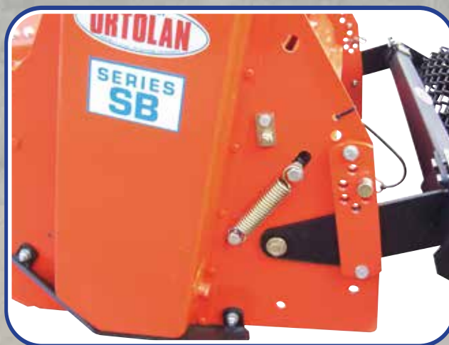
Regolazione del rullo a perni - Roller adjustment with pins - Ajustement du rouleau avec des boulons - Walzeneinstellung mit Stifte
