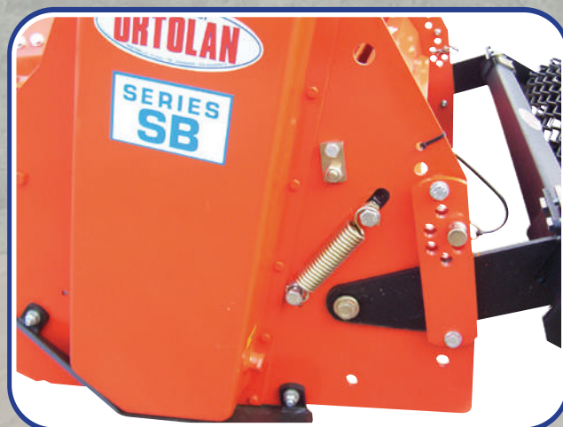
Regolazione del rullo a perni - Roller adjustment with pins - Ajustement du rouleau avec des boulons - Walzeneinstellung mit Stifte
