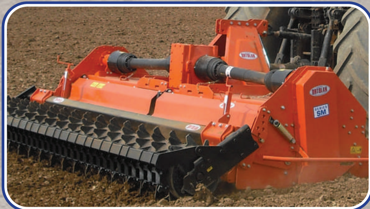
Telaio a tre punti di robusta fattezza con attacchi oscillanti nelle serie più professionali. - Strong frame three-point hitches with swinging hitches in the series more professional - Robuste attelage 3 points avec barre avant déportable dans la série plus professionnel - Stark Rahmen 3 Punkt-Anbau, schwingend Verbindung in der Serie professioneller.
